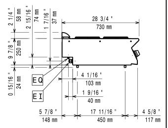
Electrical inlet (power) EQ Equipotential screw
